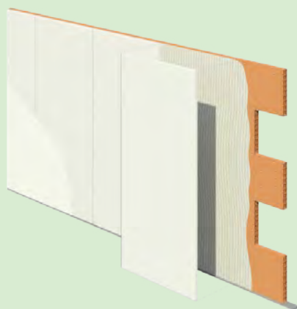
Tabiquería de ladrillo hueco gran formato con revestimiento de placa de yeso laminado (Muralit)
